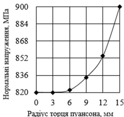
Рис. 3. Розподіл нормальних напружень на торці пуансона при максимальній величині зусилля видавлювання
