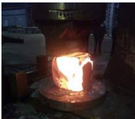
Рис. 6. Промышленный эксперимент по реализации процесса разгонки заготовки плоским бойком на ОАО «Русполимет»
