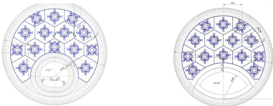
а) Камера горіння «овальної форми» площею 3,4 м 2 , висотою - 32340 мм та тангенціальним підведенням газоповітряної суміші б) Камера горіння «чечевиної форми» площею 4,79 м 2 , висотою – 32340 мм та тангенціальним підведенням газоповітряної суміші
