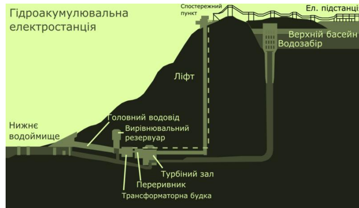
Рисунок 1 – Схема гідроакумулюючої електростанції [3]
