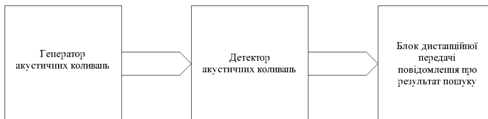
Рисунок 3 – Структурна схема системи пошуку пристроїв для інспекції нафтопроводу
