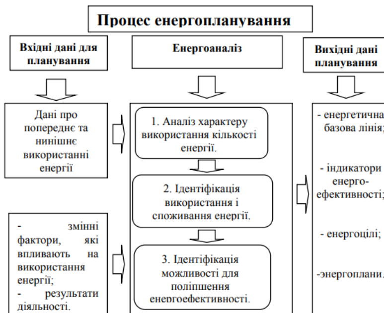
Рисунок 1 – Схема процесу енергетичного планування підприємства
