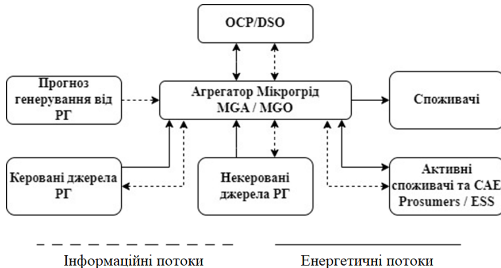
Рисунок 1 - Структура системи Smart-моніторингу Microgrid системи
