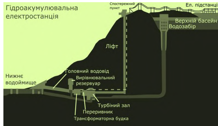
Рисунок 1 – Схема гідроакумулюючої електростанції [3]
