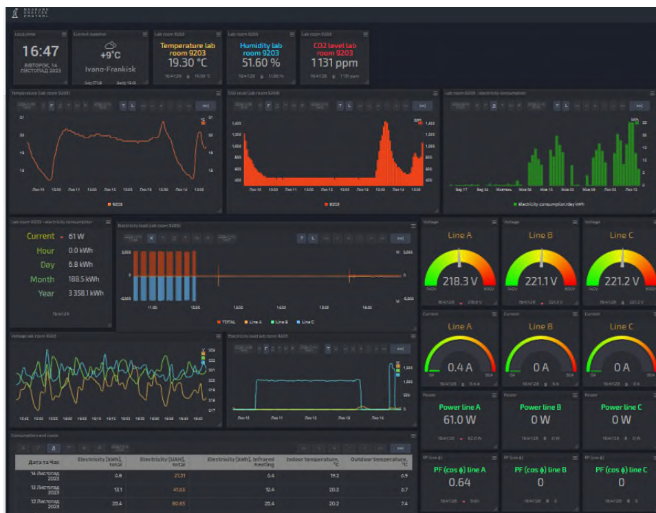
Рисунок 2 – Приклад інформаційної панелі сегменту системи енергетичного моніторингу для навчальної аудиторії університету
