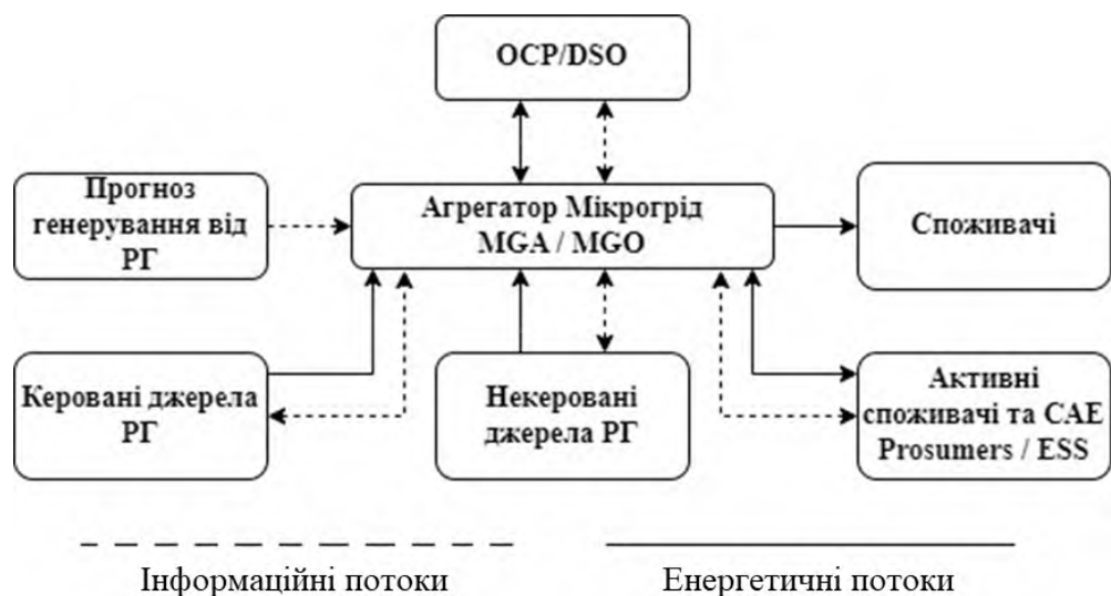
Рисунок 1 - Структура системи Smart-моніторингу Microgrid системи
