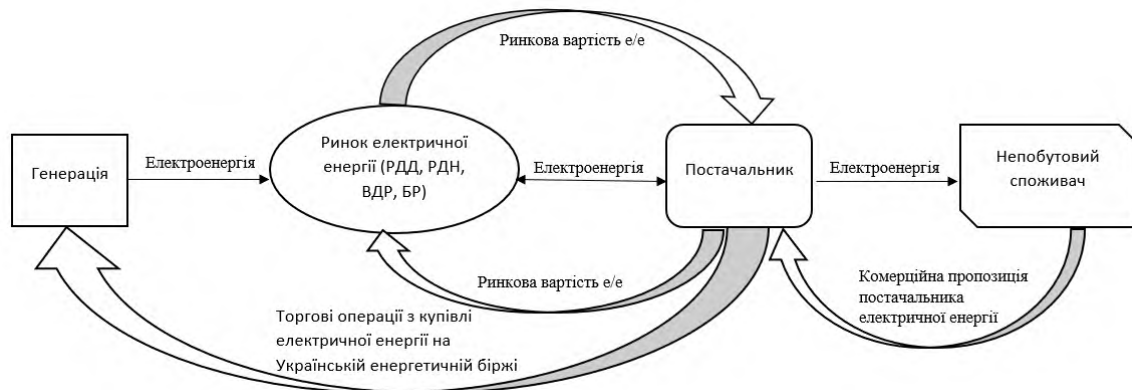
Рисунок 1 – Схема закупівлі електроенергії постачальником для побутового споживача
