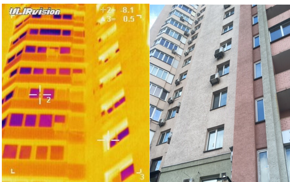
Рисунок 2 – Тепловізійна зйомка фасаду будинку
