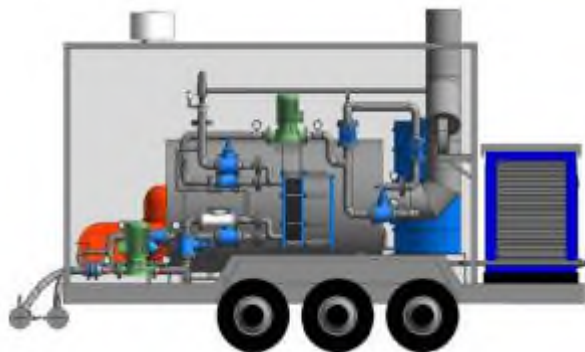
Рисунок 1 - Блочно-модульні котельні установки (МКУ) складаються з декількох модулів, які мають компактні розміри, що дозволяють їх перевезення транспортними засобами
