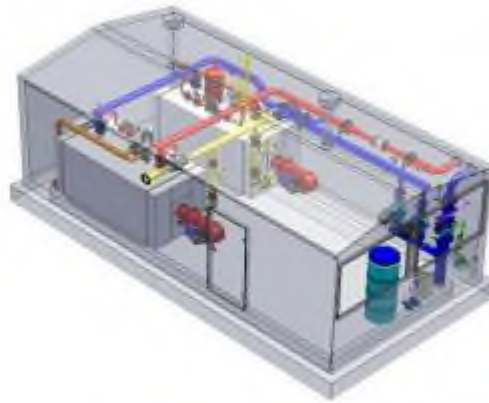
Рисунок 2 - Транспортабельні котельні установки (ТКУ) – це цілісний технологічний комплекс, повністю підготовлений до експлуатації. ТКУ являє собою контейнер, всередині якого змонтований котел, система водопідготовки, теплообмінники, насоси тощо
